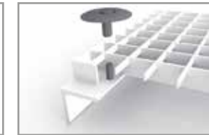
Setzbolzen-Befestigung für Maschenweite 30 x 30 mm bestehend aus: • Telleroberteil mit Gewindehülse • Gewindebolzen M8
