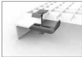
Standard-Befestigung für Maschenweite 30 x 30 mm bestehend aus: • Bügeloberteil • Sechskantschraube M8 • Vierkantschraube M8 • Vierkantmutter • Klemmunterteil
