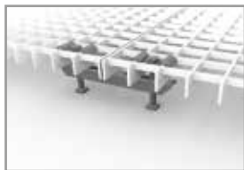
Doppelklemmen-Befestigung zur Vermeidung von Stolperkanten bei Roststößen bestehend aus: • 2 Bügeloberteilen • 2 Sechskantschrauben • 2 Vierkantmuttern • 1 Klemmunterteil
