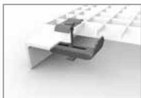
Standard-Befestigung für Maschenweite 30 x 30 mm bestehend aus: • Bügeloberteil • Sechskantschraube M8 • Vierkantmutter • Klemmunterteil
