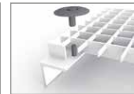
Setzbolzen-Befestigung für Maschenweite 30 x 30 mm bestehend aus: • Telleroberteil mit Gewindehülse • Gewindebolzen M8
