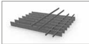
Pressroste Einfassung: T-Profil Maschenweite 20 x 20 mm Ausführung: Stahl roh und feuerverzinkt
