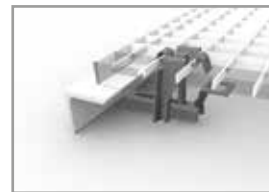
Sicherheits-Befestigung für Maschenweite 30 x 30 mm bestehend aus: • arretierendem Bügeloberteil • Sechskantschraube M8 • Vierkantmutter • Klemmunterteil
